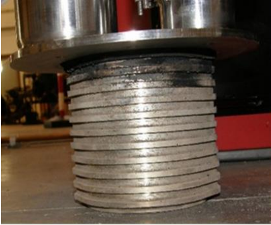
(1) Surface externe du réchauffeur Stirling après 68 h de fonctionnement avec des granulés de bois [59]
