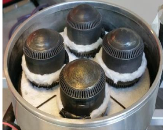
(2) Chauffage à ailettes dans un SE à double effet de 1kW utilisé dans une chaudière Whispergen [47].
