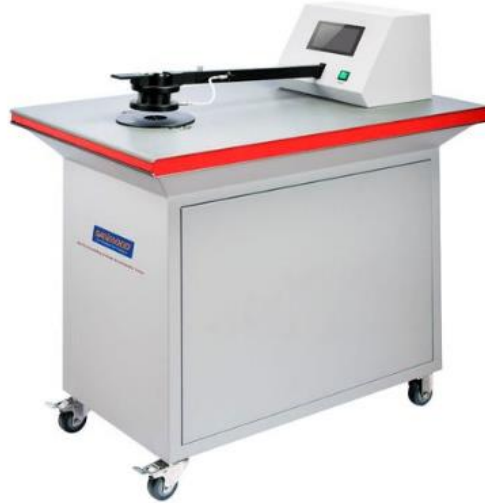
Figure 23: Testeur de perméabilité à l'air Textest FX 3300.
